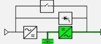
Ante incidencias en el suministro eléctrico de entrada, el SAI sigue alimentando las cargas mediante la batería sin interrupciones.
