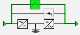
Para intervenir en el equipo (cambio baterías, ventilación, etc.), el SAI dispone de un bypass manual sin corte en la alimentación de la carga.
